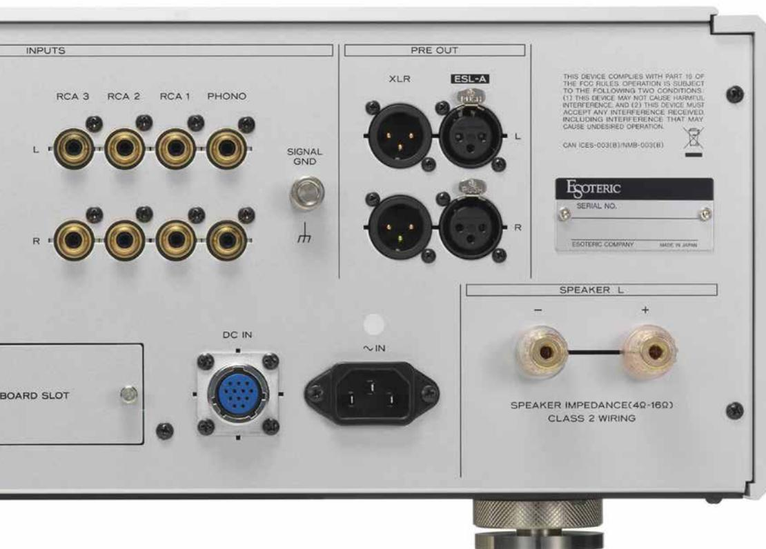
Dreimal RCA, dreimal XLR, Phono, Pre-Out und Trigger: Das Anschlussfeld des Esoteric F-02 darf als vollständig gelten, ein Slot erlaubt eine nachträgliche Erweiterung des Funktionsumfangs. Der „DC in“ neben dem regulären Netzanschluss ist für das optionale Netzteil gedacht, das ein Netzkabel im Übrigen nicht überflüssig macht: Es speist nur die Vorstufensektion des Amps.
